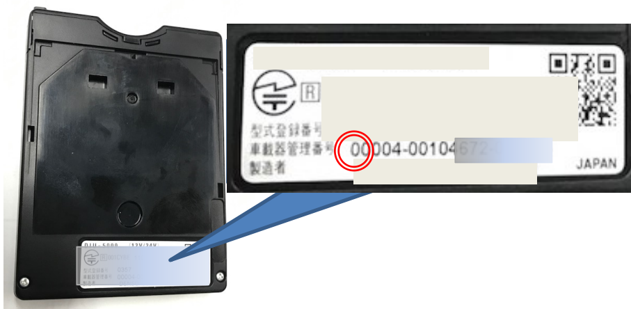
(写真): 旧セキュリティ対応車載器
